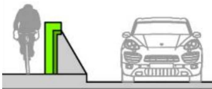
Рис. 8. Наклонный звукопоглощающий барьер
